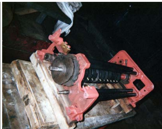
Après un bon coup de ponçage, les parties ferreuses ont été repeintes et remontées, prêtes à recevoir les autres pièces.
