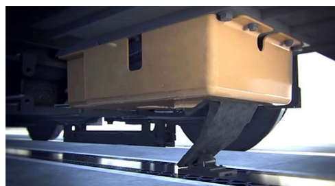
Détail du système de captation pour le rechargement.
